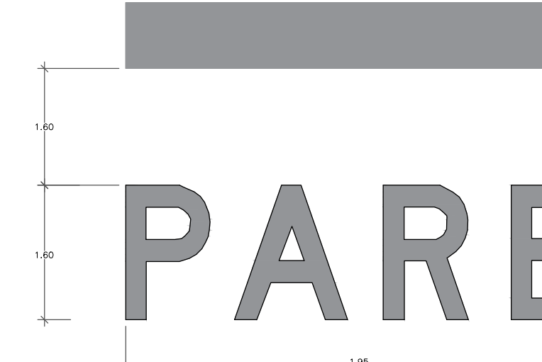
Comprimento da Legenda - 1.95m Altura da Legenda - 1.60m Distância Retenção - 1.60m Área unitária - 1.58m 2
